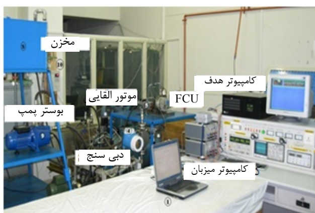
شکل ۴ بستر سیستم تست FCU
