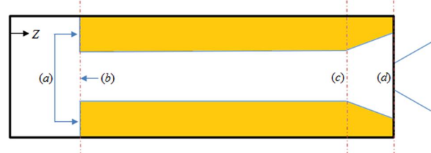
شکل 15 شماتیکی از هندسه موتور NAWC N.13
