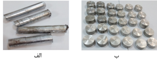
شکل ۲ الف: بیلت کامپوزیت ریخته‌گری شده ب: ماشین کاری و برش کاری بیلت‌ها
