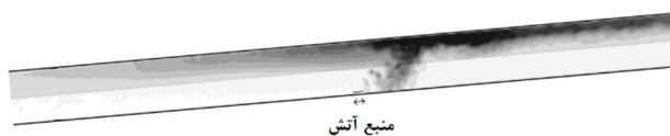
شکل 7 جریان سیال (دود) در تونلی با شیب (+5) درجه - محل آتش‌سوزی در فاصله 5/3 متری از ورودی تونل و روی خط مرکزی - نرخ گرمای آزاد شده 55/9 کیلووات
