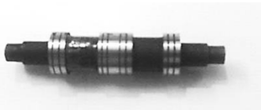
شکل ۲ تصویر اسپول شیر هیدرولیک
