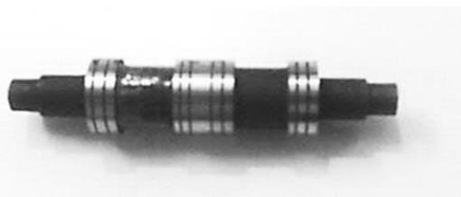
شکل ۲ تصویر اسپول شیر هیدرولیک
