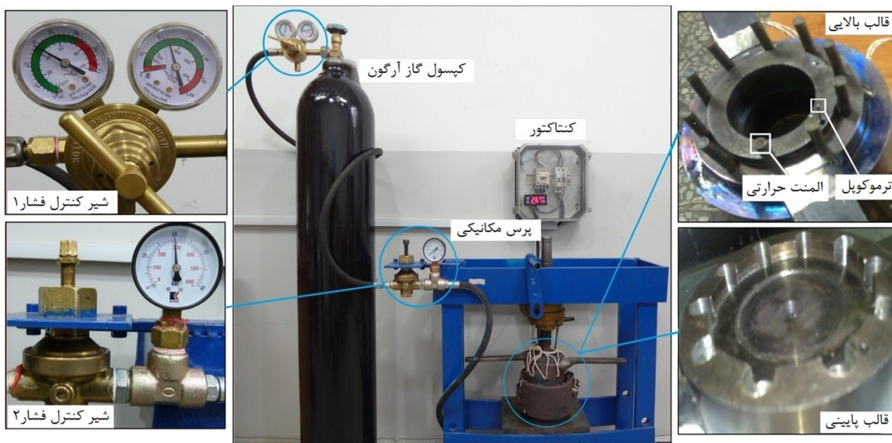
شکل 4 نمایی از واحد اعمال فشار گاز، پرس و تجهیزات آزمایش
