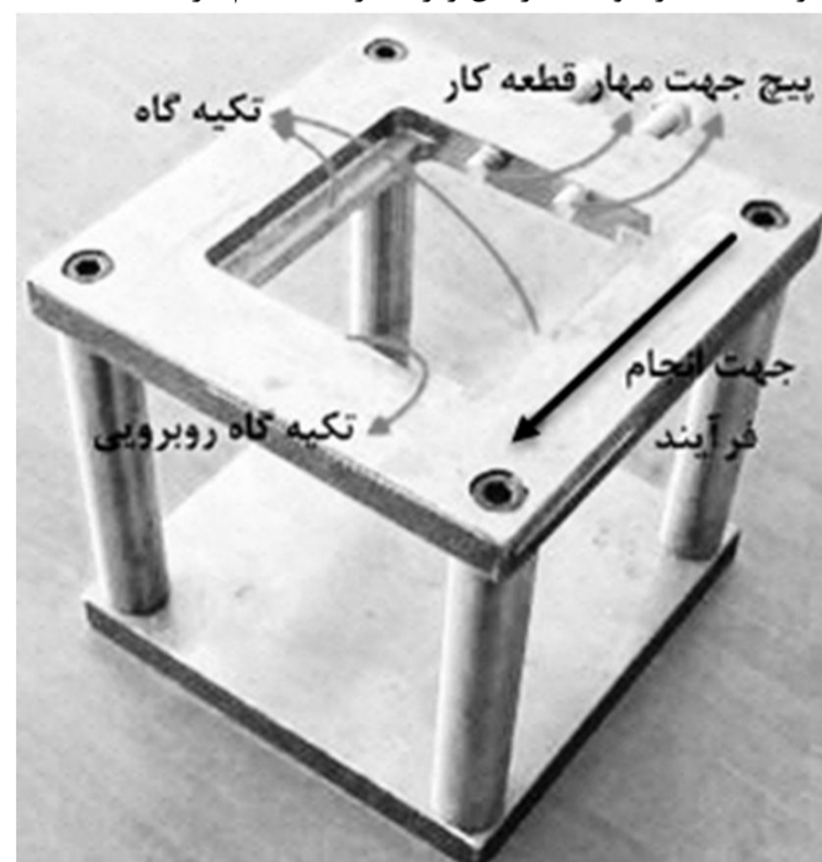
شکل 3 نمایی از قید و بند ساخته شده برای مهار سیستم ارتعاشی التراسونیک
