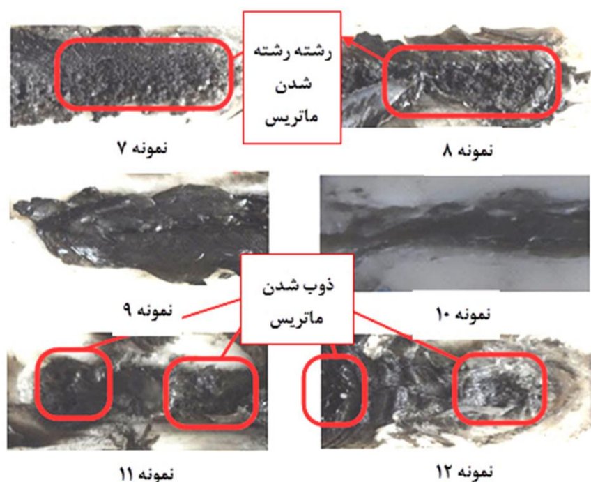
شکل 5 سطح ظاهری نانوکامپوزیت‌های تولیدی در حضور ارتعاشات التراسونیک
