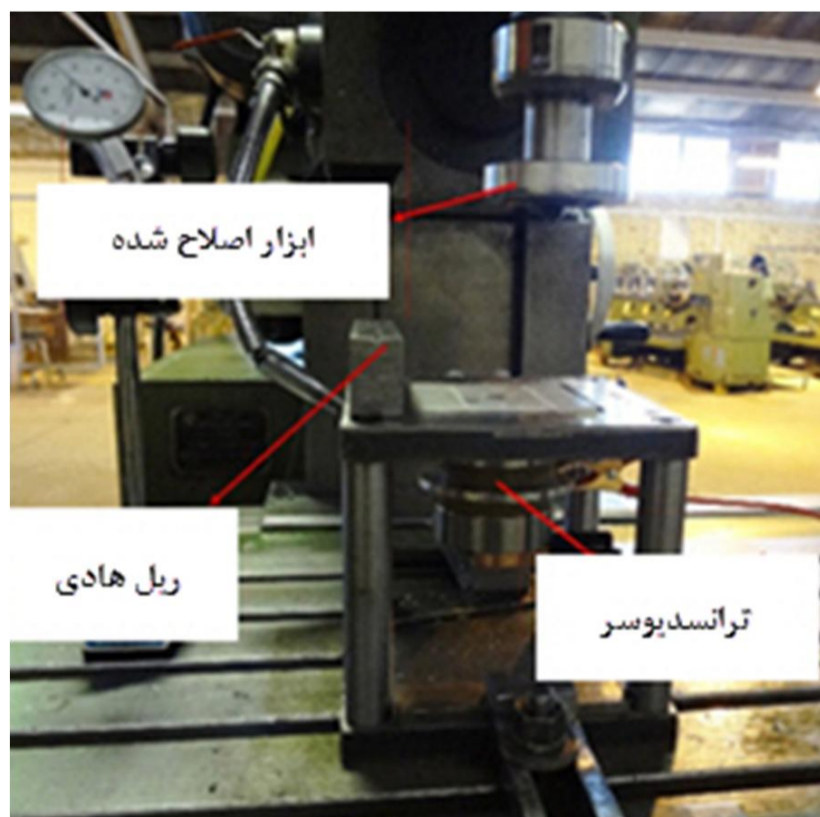
شکل 2 مکانیزم شانه غیرقابل دوران ابزار اصلاح شده فرآیند اصطکاکی اغتشاشی
