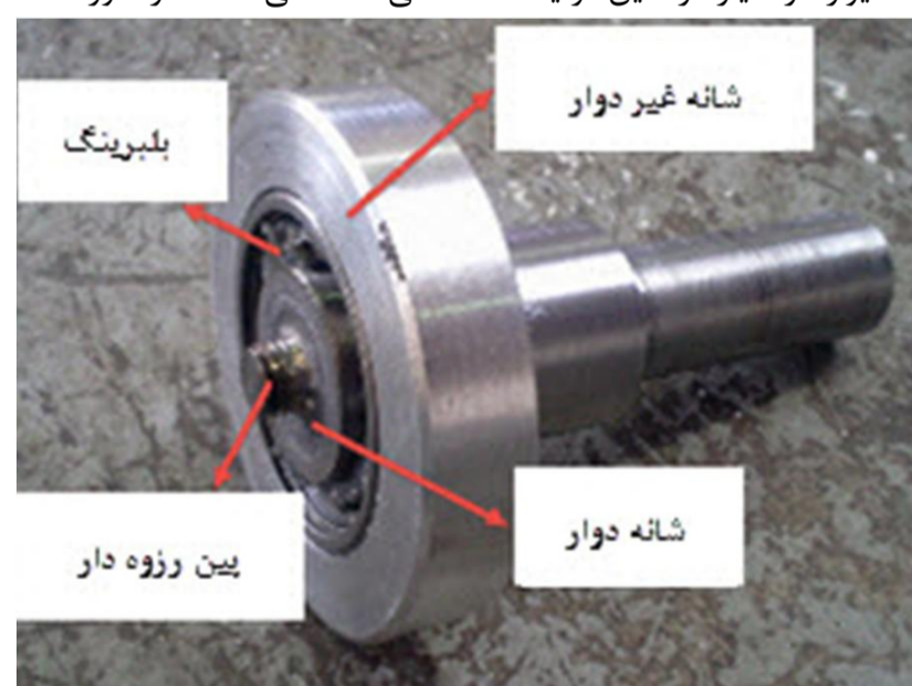
شکل 1 نمایی از ابزار اصلاح شده فرآیند اصطکاکی اغتشاشی
