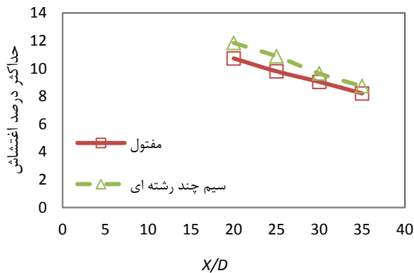
شکل ۱۰ توزیع حداکثر شدت اغتشاش جریان هوا برحسب فاصله بی بعد (X/D) برای عدد رینولدز ۱۵۷۰
