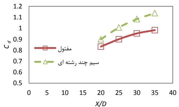
شکل ۱۳ توزیع ضریب نیروی پسا بر حسب فاصله بی‌بعد شده در پایین دست مدل‌های مورد آزمایش برای عدد رینولدز ۱۵۷۰
