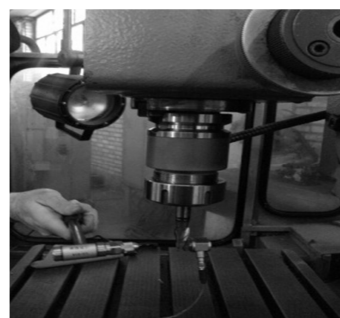
شکل ۳ نحوه انجام آزمایش مودال ابزار
