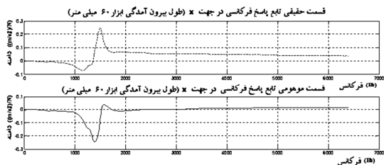
شکل ۵ نمودار تابع پاسخ فرکانسی در جهت X برای طول بیرون آمدگی ابزار برابر ۶۰ میلی متر
