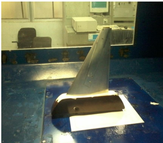
ب- نحوه قرارگیری مدل در مقطع آزمون
