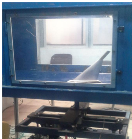
شکل 2 تست مدل در مقطع آزمون تونل باد مادون صوت
