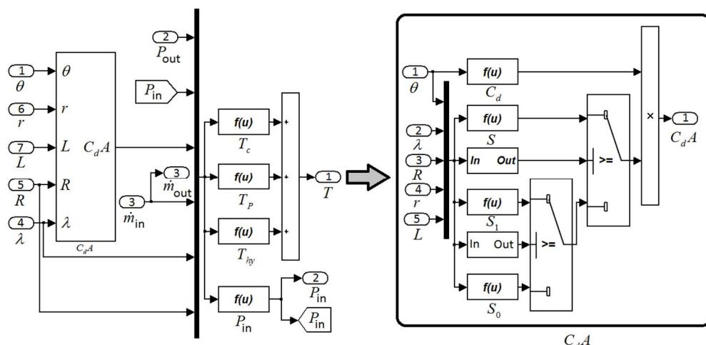
شکل 11 مدل شبیه‌ساز عملگر در محیط نرم‌افزار سیمولینک
