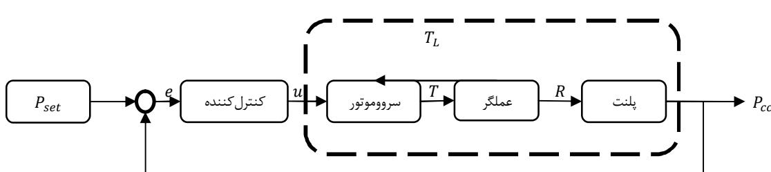
شکل 2 مودار جعبه‌ای حلقه بسته‌ی سیستم
