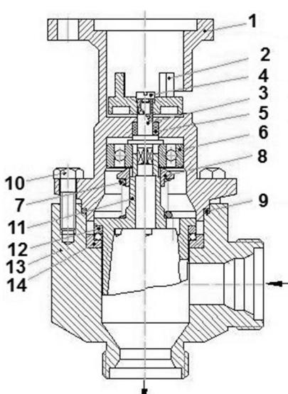
شکل 10 اسکچ عملگر هیدرومکانیکی (جزا در متن اشاره شده‌اند)
