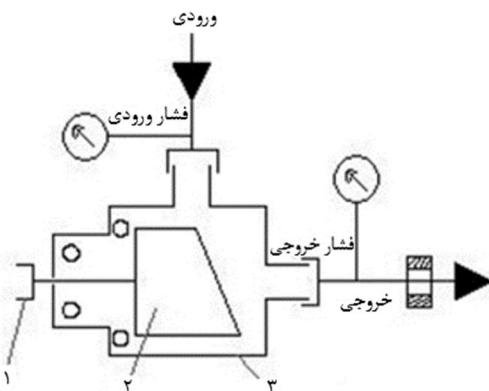
شکل 7 طرح ساختاری عملگر: 1- نیم کوپلینگ اتصالی به نیم کوپلینگ سروموتور
