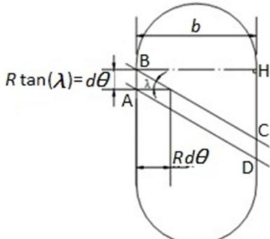
شکل 8 مقطع لوپیایی شکل ورودی بدنه به درچه
