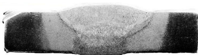
شکل 4 سطح مقطع اتصال جوش
