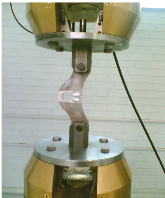
شکل ۱۰ تصویری از نمونه جدید که بر روی دستگاه جهت انجام آزمون خستگی قرار گرفته است
