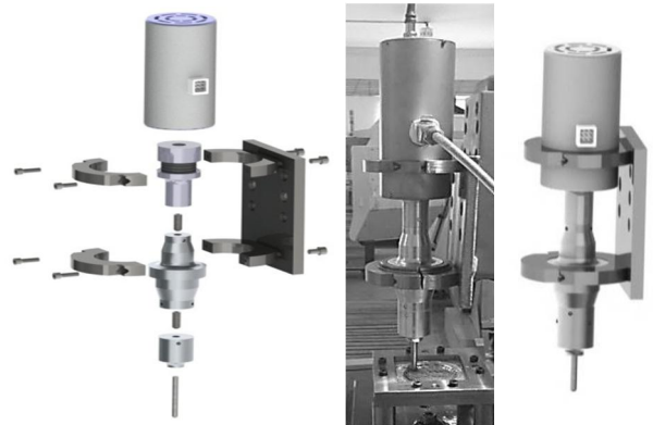
شکل 7 کنگی شکل‌دهی افزایشی با امواج آلتراسونیک
