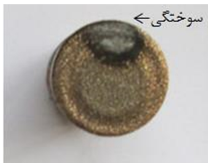
شکل ۷ سوختگی ابزار مس-قلع
