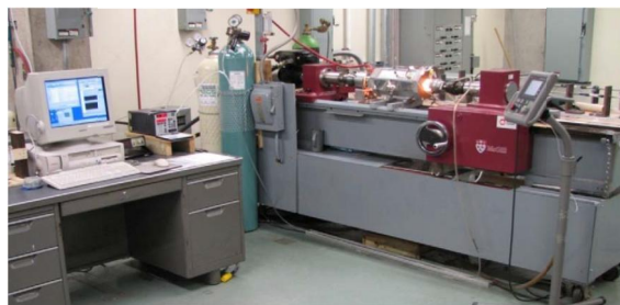
شکل 2 دستگاه پیچش گرم مجهز به رایانه [13].
