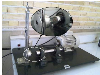
شکل ۲ دستگاه تست خستگی و فک‌های اتصال نمونه
