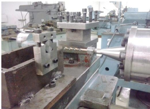
شکل ۱ مجموعه ابزار گیر و فیکسچر و قطعه کار
