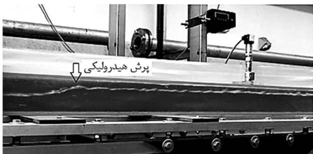
شکل 21 وقوع پرش هیدرولیکی در قسمت افقی بالادست مقاطع شیب‌دار
