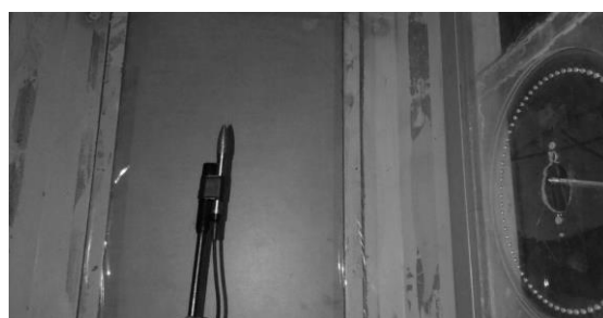
Fig. 3 Photograph showing the microphone mounted in the test section شکل 3 تصویری از میکروفون نصب شده داخل اتاق آزمون
