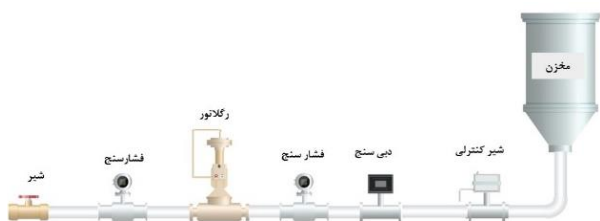
شکل ۱) شماتیک چینش آزمایش
