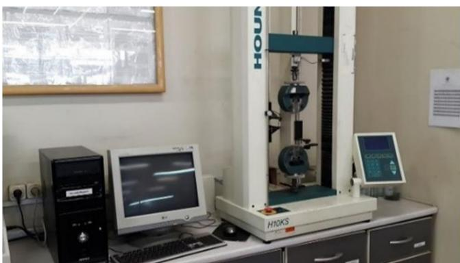
شکل 3 دستگاه کشش هانسفیلد و تجهیزات جانبی
