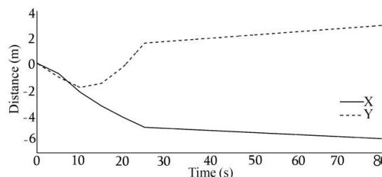
شکل 15 مسیر افقی و عمودی ربات ماهی در شبیه‌سازی سیستم حلقه بسته برای حالت دوم
