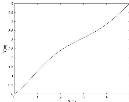
شکل 14 مسیر حرکت ربات ماهی در شبیه‌سازی سیستم حلقه بسته برای حالت اول
