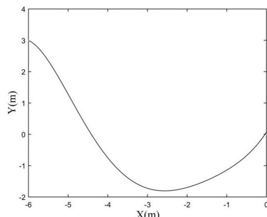
شکل 16 مسیر حرکت ربات ماهی در شبیه‌سازی سیستم حلقه بسته برای حالت دوم
