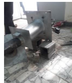
شکل ۲۳) نمای آزمایشگاهی لوله تابشی مورد آزمون
