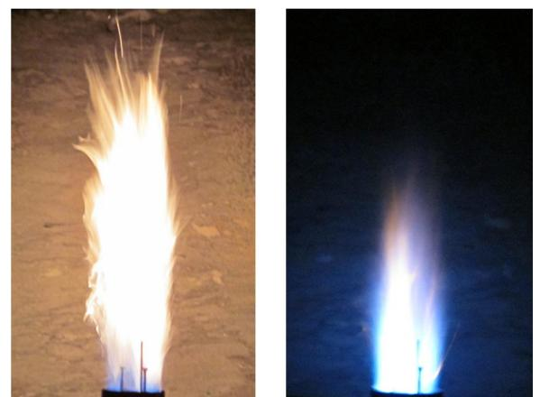
شکل 2 تصویر شعله بدون تزریق (راست) و با تزریق قطرات گازوئیل (چپ)
