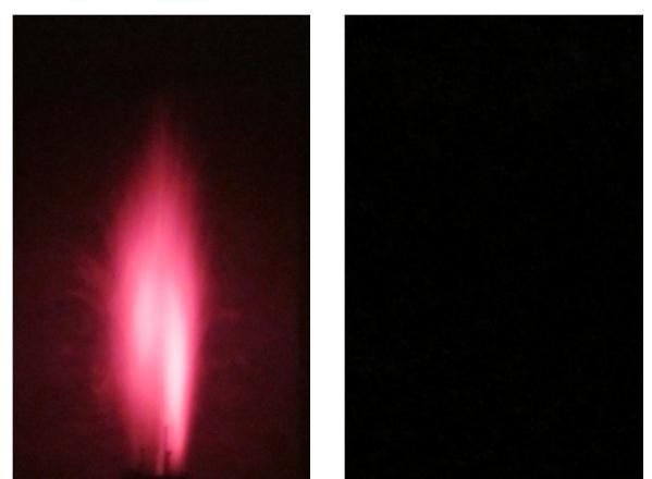
شکل 4 توزیع کیفی ذرات دوده در شعله با استفاده از فیلتر مادون قرمز برای حالت بدون تزریق (راست) و با تزریق قطرات گازوئیل (چپ)
