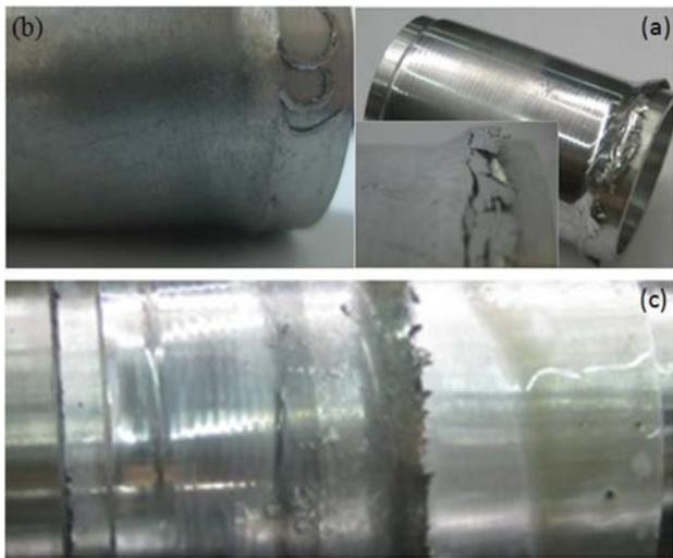
**شکل 3** انباستگی شدید مواد در مقابل گلتک که منجر به ناپایداری جریان پلاستیک و برآمدباری از سطح شده است. شرایط آزمون ها: مقدار پیشروی 0.11 میلی متر بر دور و نسبت کاهش ضخامت (a)-(b) 33% و (c)- 16.6% - متغیر از 33% به 16.6% در حین فرایند
