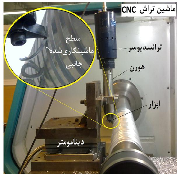
شکل ۹ عملیات برادهبرداری از سطح جانبی قطعه کار در فرآیند تراشکاری UAT.
