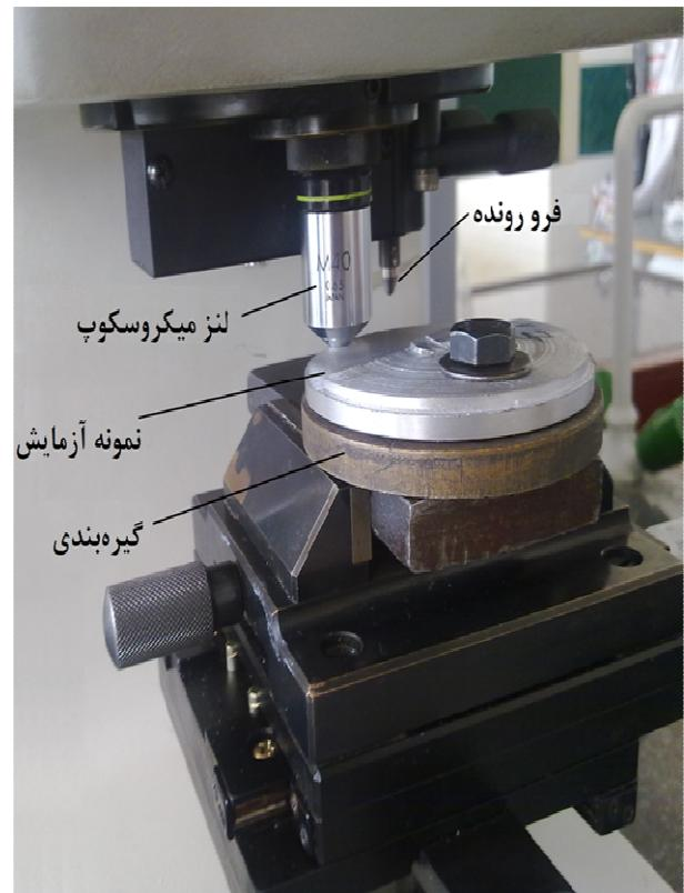
شکل ۱۰ اندازه‌گیری میکرو سختی روی سطح ماشینکاری شده جانبی در فرآیند تراشکاری UAT.
