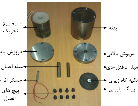
شکل ۱۷ اجزای حسگر نیروی مگنتواستریکتیو
