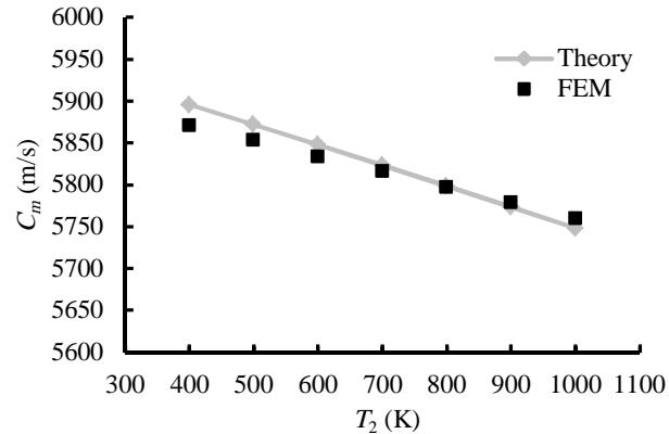
شکل ۹ اثر دمای  $T_2$  بر سرعت  $C_m$  به صورت عددی و تئوری
