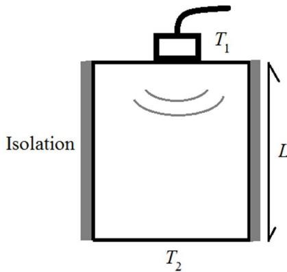
**شکل ۱** نحوه انتقال حرارت و ارسال امواج فراصوتی به روش بازتابی در حضور یک گرادیان درجه حرارت
