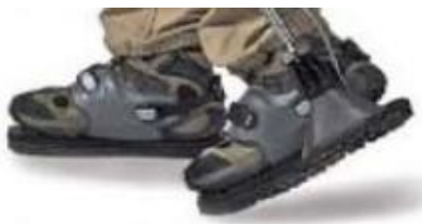
شکل ۹ چگونگی اتصال پنجه پای کاربر و ربات
