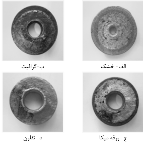
شکل ۸ نمونه‌های فشار داده شده تحت روانکارهای مختلف
