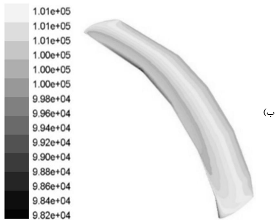
شکل 18 توزیع فشار بر حسب پاسکال روی سطح بال تغییر شکل یافته گال، الف) زاویه حمله صفر درجه، ب) زاویه حمله 15 درجه
