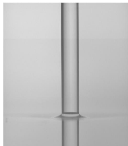
شکل 5 تصویر از بالای جت سیال در برخورد با سطح آزاد سیال در حالت ساکن V_j=3/47 m/s و D_j=3/77 mm و V_i=0/0 m/s
