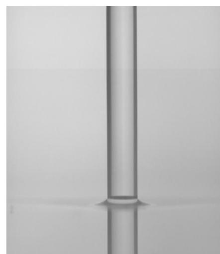
شکل 5 تصویر از بالای جت سیال در برخورد با سطح آزاد سیال در حالت ساکن  $V_j=3/47 \text{ m/s}$ ,  $D_j=3/77 \text{ mm}$ ,  $V_i=0/0 \text{ m/s}$
