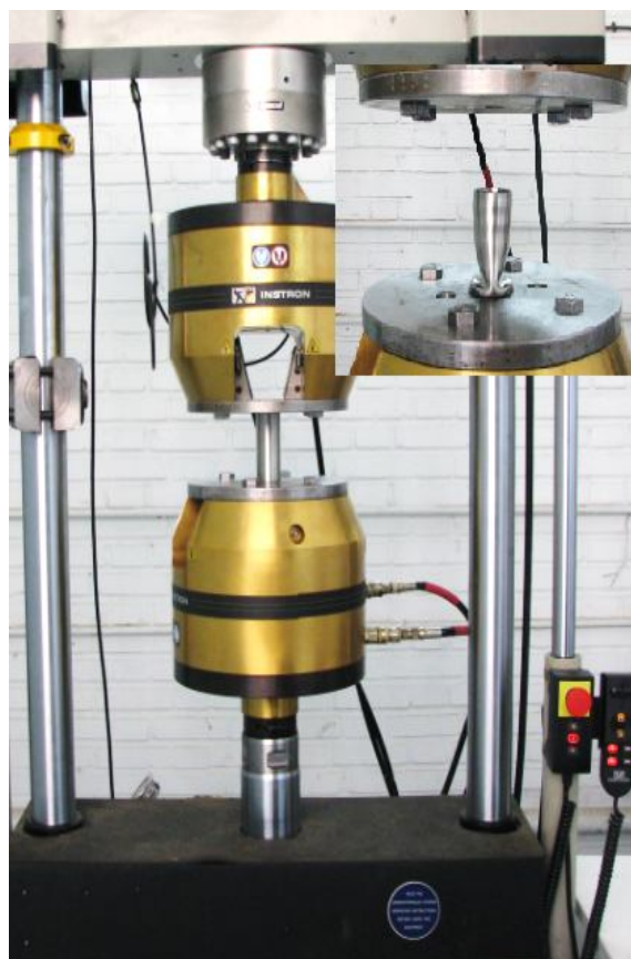
شکل ۱۶ دستگاه اینسترون ۸۸۰۲ در حال بارگذاری روی یک نمونه استوانه‌ای به وسیله صفحه صلب
