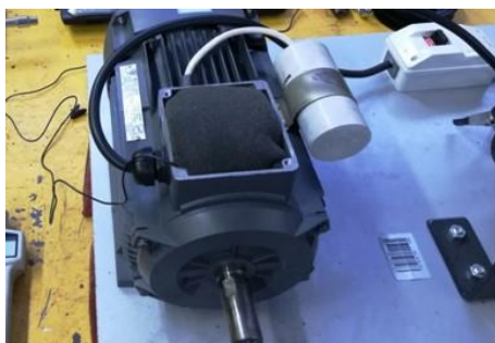
شکل ۳) میکروفن مورد استفاده جهت داده‌برداری و چگونگی نصب آن
