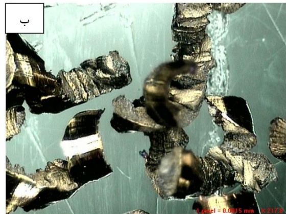
شکل ۱۲) براده حاصل از ماشین‌کاری الف) خشک و ب) برودتی فولاد زنگ‌نزن AISI 440C با نرخ پیشروی ۰/۰۹ میلی‌متر بر دور
