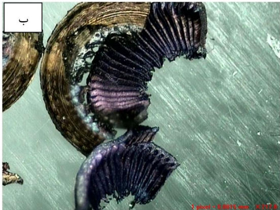
شکل ۱۳) براده حاصل از ماشین کاری الف) خشک و ب) برودتی فولاد زنگ‌نزن AISI 440C با نرخ پیشروی ۰/۱۸ میلی‌متر بر دور
