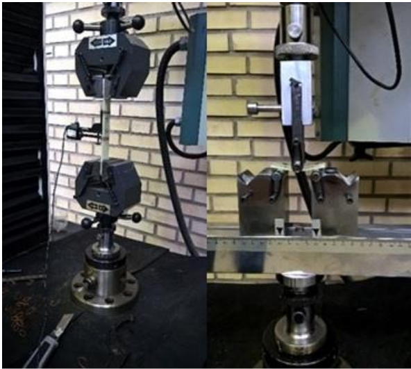
شکل ۲) تنظیمات آزمایش الف) کشش، ب) خمش سه نقطه
