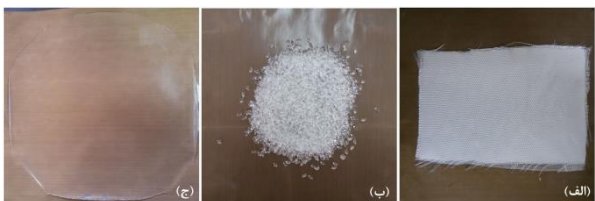
شکل ۲) الف) الیاف شیشه گرید E دوجهته، ب) گرانول پلی‌یورتان و ج) ورق پلی‌یورتان ساخته شده از آن
