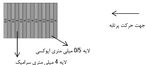
شکل 6 نمونه‌ای از لایه چینی مربوط به کد 7(E(0.5)C(4))
