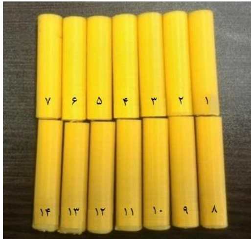
شکل ۵) نمونه‌های ساخته شده با دستگاه لایه نشانی ذوبی
