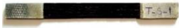
شکل ۴) نمونه کامپوزیت کربن-اپوکسی آماده انجام آزمون به همراه تب در دو طرف آن
