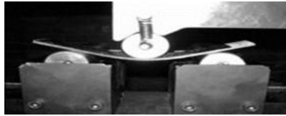
شکل ۶) نمونه کامپوزیتی ساخته شده تحت آزمون خمشی
