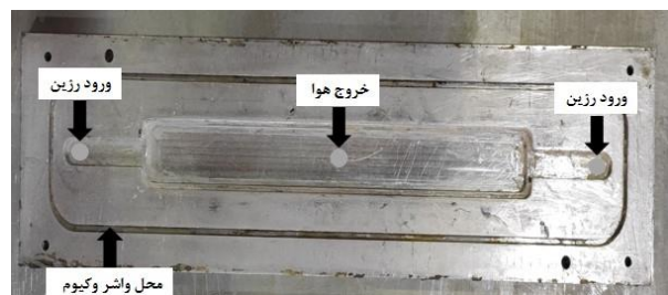
شکل ۳) قالب ساخته شده جهت انجام عملیات ساخت نمونه‌ها و ارزیابی
