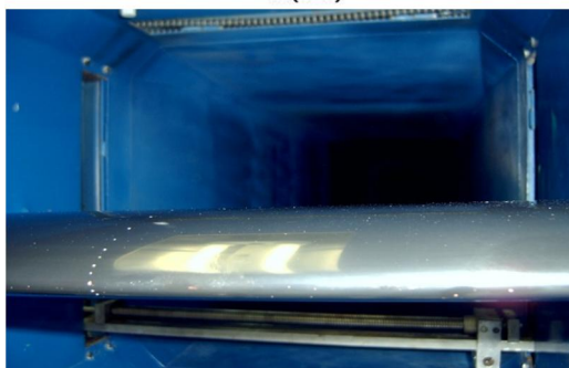
شکل 4 مقطع و نمایی از مدل ایرفویل مورد آزمایش [8]
