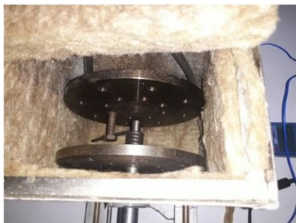
شکل ۶) نمای داخل کوره و عایق بندی آن
