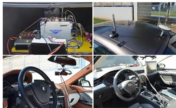
شکل ۵) خودروهای تست، سنسورها و تجهیزات جمع‌آوری داده [30]
