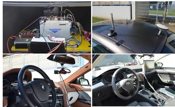
شکل ۵) خودروهای تست، سنسورها و تجهیزات جمع‌آوری داده [30]
