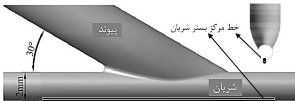
شکل 1 هندسه استفاده شده برای پیوند بای پس انتها به پهلو، شکل کوچکتر نمایی از روبروی پیوند را نشان می دهد.
